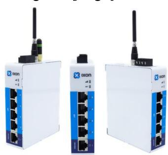
IXrouter è un router VPN industriale combinato e gateway IoT edge. Collega controlli della macchina, HMI, robot e tutti gli altri dispositivi industriali della macchina sul lato LAN dell'IXrouter. Non appena l'IXrouter accede a Internet, si registra automaticamente su IXON Cloud.
